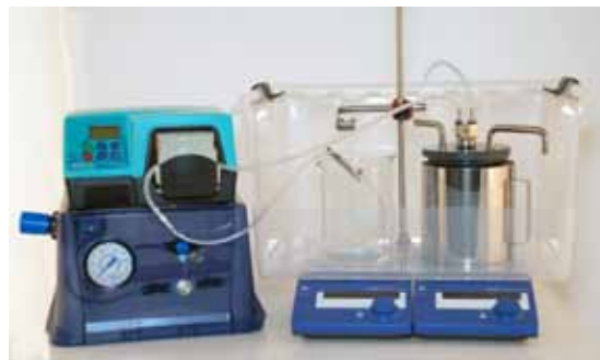
Frysgranulator av labbskalemodell (LS-2, Powderpro AB).
